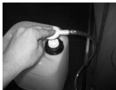
Utiliser uniquement de l'eau distillée. De l'eau non distillée peut contenir des particules qui pourraient être néfastes aux performances et durée de vie de vos batteries et annuler la garantie.
